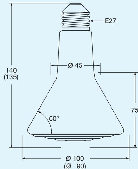
Bild 68: Einbaumaße und Strahlerabmessungen ( ) in mm
